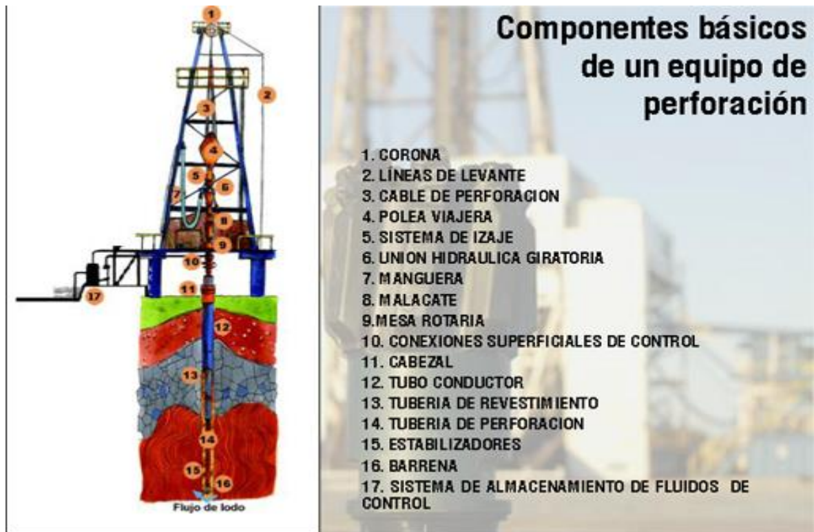
Figura 1. Muestra todos los componentes de un equipo de perforación.
